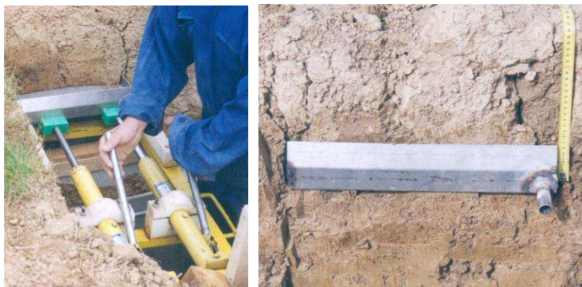
Photographie 11. Mise en place des plaques lysimétriques sur le site de la Bouzule
