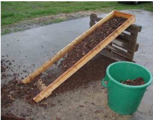
Photographie 4. Seconde étape de criblage à 1,9 cm
