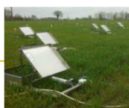
Figure 3 : Instrumentation du profil de sol et chambres de suivi d'émissions de CO 2 / N 2 O
