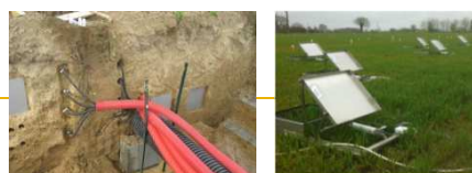
Figure 3 : Instrumentation du profil de sol et chambres de suivi d'émissions de CO 2 / N 2 O
