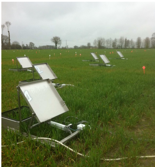
Figure 4. Vue d'ensemble des 6 chambres automatiques disposées sur deux placettes (3 chambres par parcelle expérimentale) et schéma du dispositif
